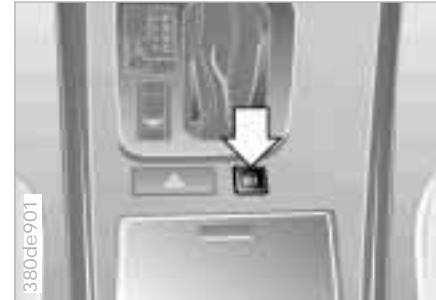
Nach dem Anfahren verriegelt sich Ihr Fahrzeug ab einer Geschwindigkeit von 8 km/h selbstständig. Im Bedarfsfall kann jederzeit manuell über die Taste für Zentralverriegelung (Pfeil) oder die inneren Türgriffe entriegelt werden.
