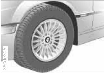
Das BMW Notlaufsystem mit integriertem Stützring ermöglicht auch bei einem plötzlichen Druckverlust im Reifen eine Weiterfahrt.
