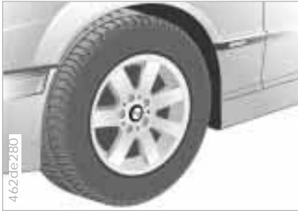
Le système BMW de secours en cas de crevaison permet, grâce à la couronne de soutien intégrée dans chaque pneu, de continuer à rouler même en cas de dégonflage soudain.
