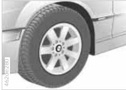
Il sistema di pneumatici per marcia d'emergenza BMW con anello di sostegno incorporato consente di proseguire la marcia anche in caso di perdita improvvisa di pressione.
