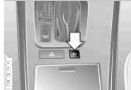
Après le démarrage, le véhicule se verrouille automatiquement dès que la vitesse atteint les 8 km/h. Le verrouillage peut en cas de nécessité être supprimé manuellement en actionnant la touche de verrouillage centralisé (flèche) ou l'une des poignées intérieures des portières.
