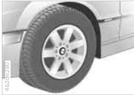
El sistema de marcha de emergencia BMW con anillo de apoyo integrado permite continuar el viaje incluso si se pierde repentinamente el aire del neumático.
